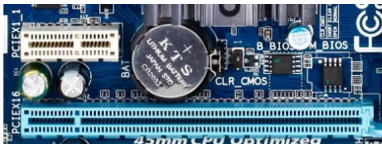
En haut (en blanc) : un port PCIe 2.0 x1. En bas (en bleu) : un port PCIe 2.0 x16.
